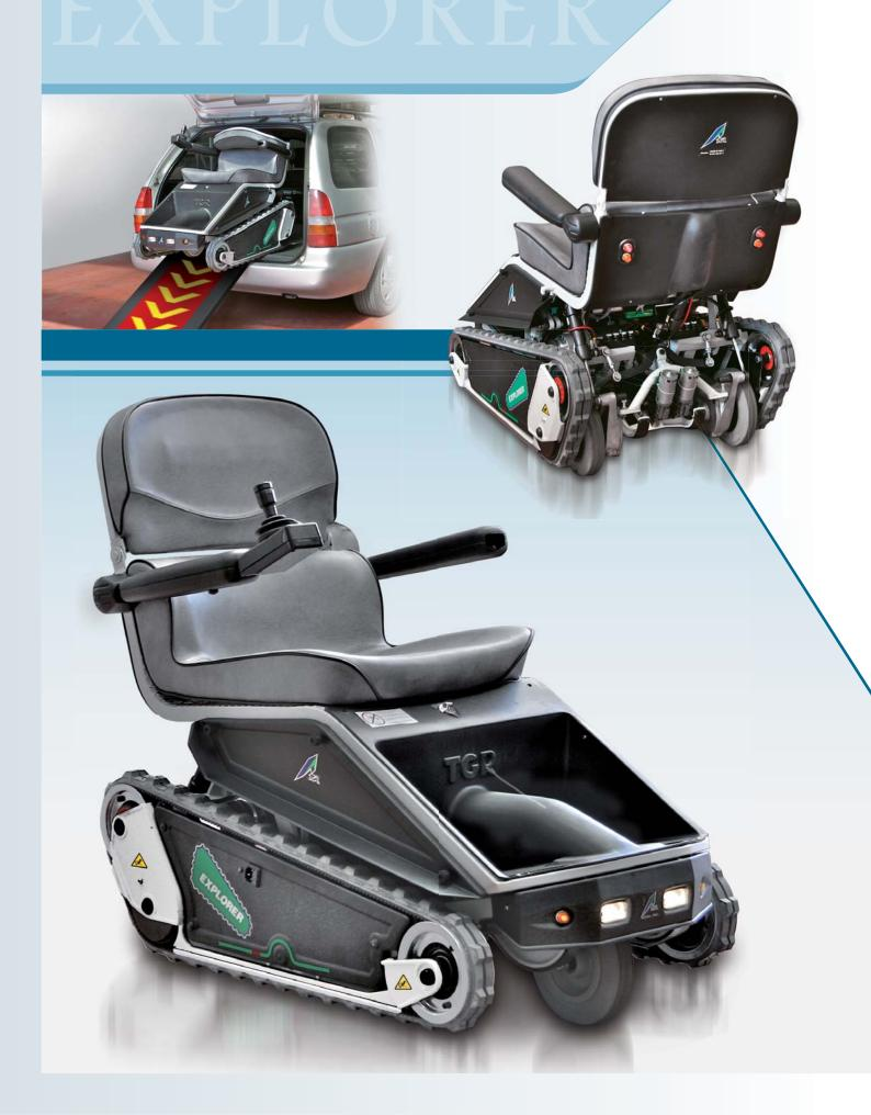
**Explorer** è dotato di un sistema, azionabile dal conducente, in grado di alternare i cingoli alle ruote, a seconda che ci si trovi sulle scale o in piano.
